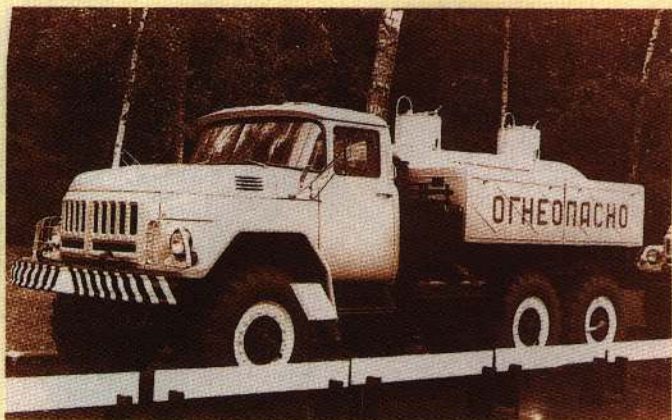
Маслозаправщик «МА-4А» на шасси ЗИЛ-131 строился Реутовским заводом «Стройоборудование» с 1969 по 1978 год. Фото автора
