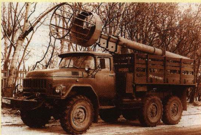
Телескопические вышки «ВТ-23» на шасси ЗИЛ-131А широко использовались при ремонте городских электросетей. Фото автора
