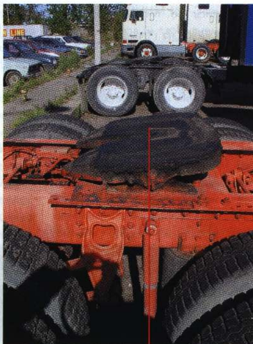
Колесная база трехосного американского грузовика считается от центра передней оси до задней точки среднего моста (края покрывки). В стандартном исполнении задним центром может служить расположение пальца полуприцепа. Для двухосного американского тягача — от центра передней оси до центра задней оси. Необходимо помнить, что седло американского тягача можно легко сдвинуть. Предусмотрено это на случай частой и быстрой смены полуприцепов различного назначения, имеющих разную длину от передней стенки полуприцепа до пальца (рефрижератор, контейнеровоз и др.)
