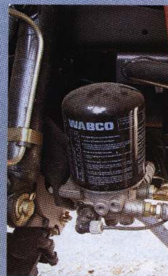
Осушитель воздуха Wabco расположен перед правым колесом. Влага и грязь постоянные спутники
