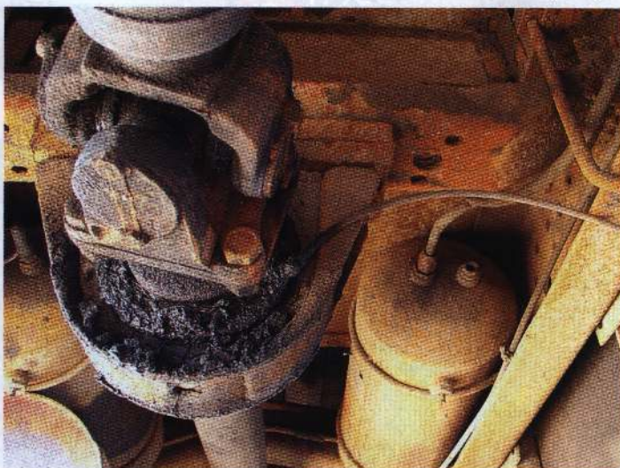
Подвесной подшипник опущен примерно на 45 мм. Видна трубка, подводящая смазку
