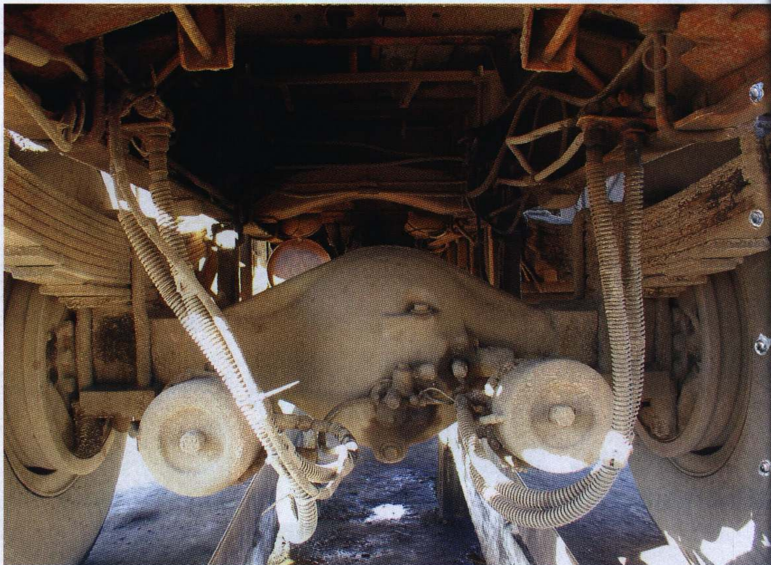
Мост Раба. Энергоаккумуляторы – камазовские, с удлиненными штоками
