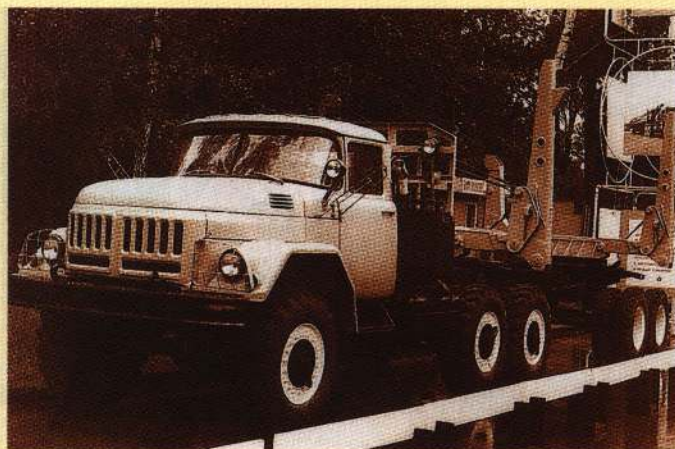
Электромеханизированный автопоезд-лесовоз «2ТМ» становится одним из основных перевозчиков древесины в 1974 – 1980 годах. Такие автопоезда изготавливались Тавдинским механическим заводом. Фото автора
