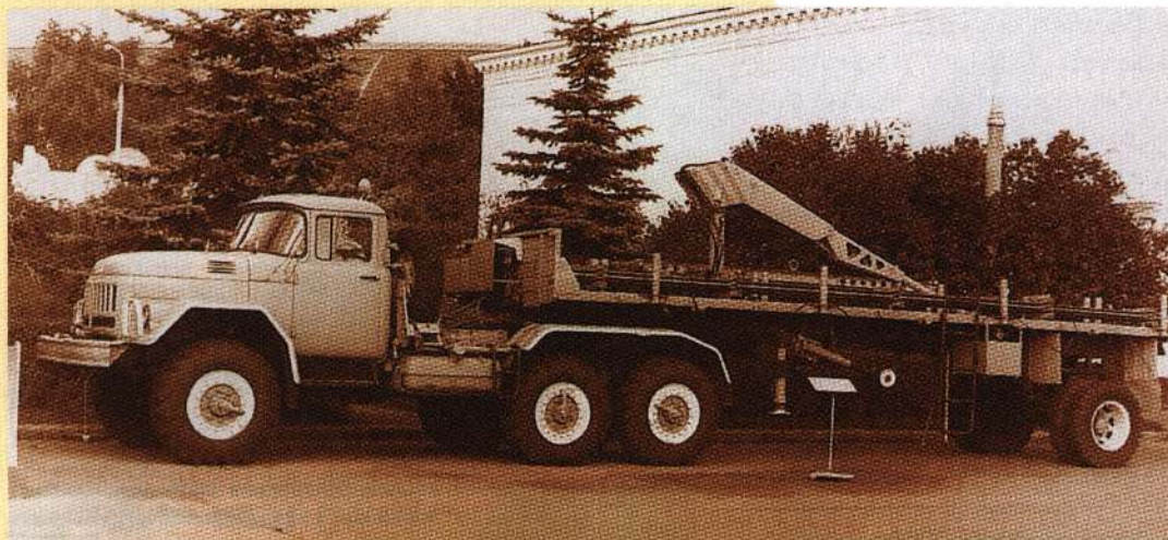
Седелный автопоезд для транспортировки буровых стволов, состоящий из тягача ЗИЛ-131 В и полуприцепа с установленным на нем гидравлическим краном 4030. 1970 год. Фото автора
