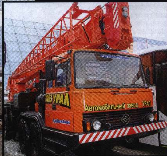
4-осное полноприводное шасси для монтажа на нем различных установок и оборудования
