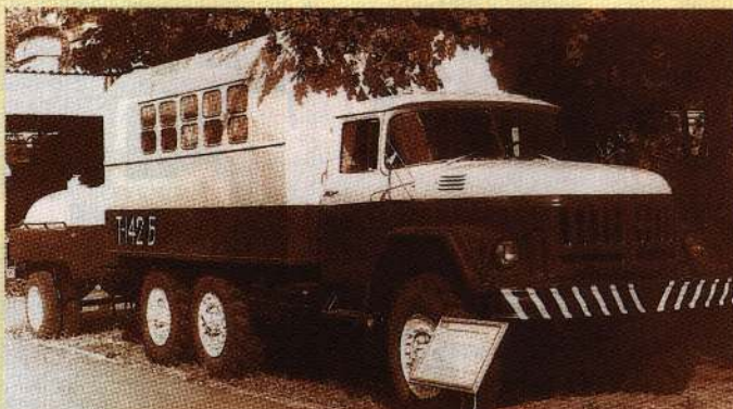
Автомастерские «Т-142 Б» комплектовались прицепом-цистерной для перевозки ГСМ. Они оказались незаменимы для ремонта и обслуживания тракторов и автомобилей в полевых условиях. Фото автора
