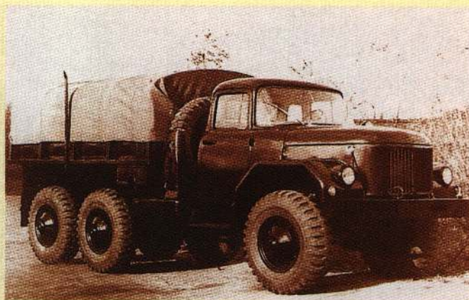
Экспериментальный автомобиль повышенной проходимости ЗИЛ-165, ставший прототипом ЗИЛ-131, был построен в 1956 году. Фото из архива А.С. Исаева
