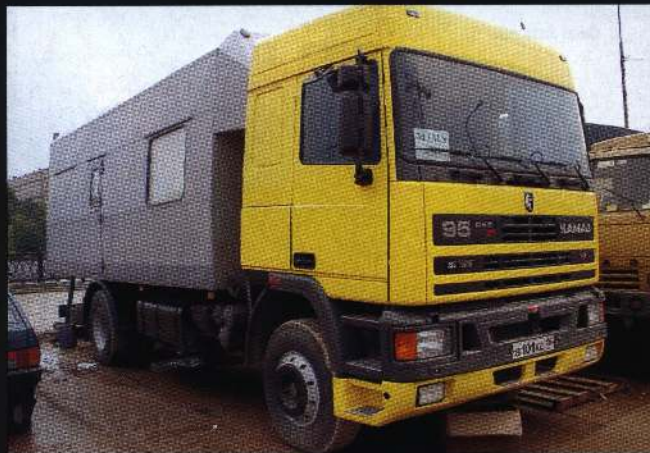
Это не DAF — это КамАЗ с иностранной кабиной. Эксперименты с голландцами закончились тем, что на челнинское шасси заводчане для своих нужд установили импортную кабину. И правильно сделали: ездить в камазовской кабине одно мучение, а здесь комфорт на высоте. Так получился заводской грузовик с жилым фургонном
