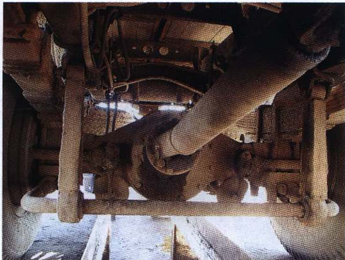
Кардан укорочен на 7 см. Стойки стабилизаторов удлинены вставками
