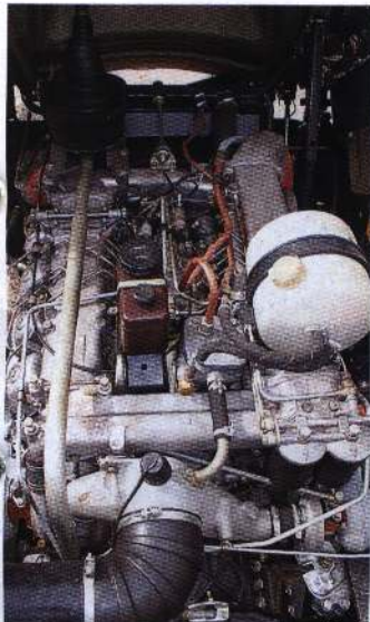
V-образный 8-цилиндровый двигатель с импортными турбинами
