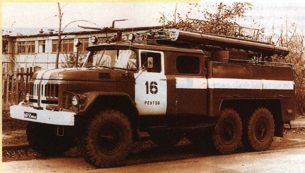
Пожарный автомобиль-цистерна «АЦ-40 (131)» модели 137 Торжонского завода противопожарного оборудования предназначался для тушения огня водой или воздушно-механической пеной. Фото автора
