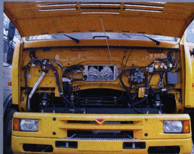
Газовый амортизатор моста не нашлось. Опорная стойка из проволоки не самое удачное решение
