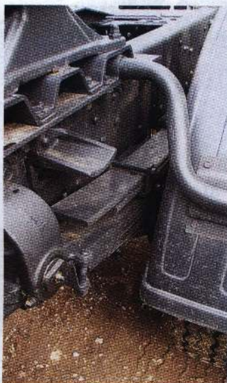
Рессорная подвеска не позволит работать с полуприцепом более 80 м³
