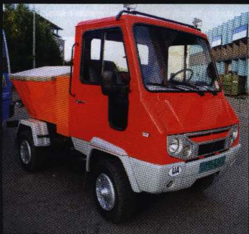
БАЗ-3340 «Терек» из украинского города Борисполя. Машина предназначена для коммунальных нужд. Передняя балка и задний мост от УАЗа, подвеска рессорная, полная масса 2800 кг. Двигатель или дизельный Алдора мощностью 90 л.с., или карбюраторный ЗМЗ-4021. Простят $ 6 тыс.
