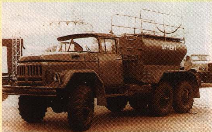
В 1974 году на ВДНХ демонстрировалась автоцистерна для транспортировки цемента модели 9975 на шасси ЗИЛ-131 Красногорского завода цементного машиностроения, однако их серийное производство так и не было налажено. Фото автора
